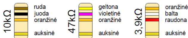
3 pav. Spalvinis rezistorių žymėjimas
